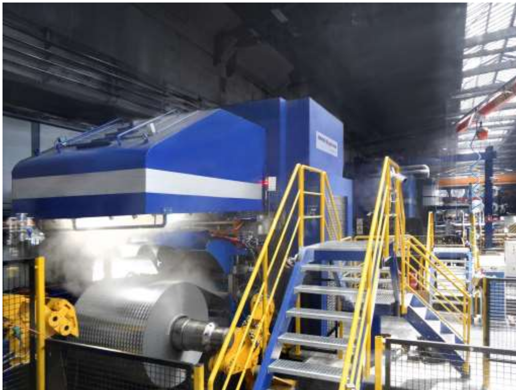
Produktion von Riffelblechen auf der von der SMS group modernisierten Aluminium-Kaltwalzanlage.
