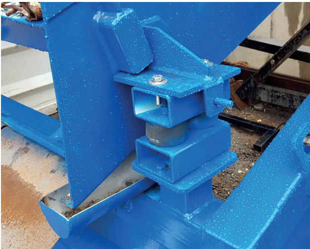
Ursprüngliche Situation mit eingesetzten Gummidämpfern
