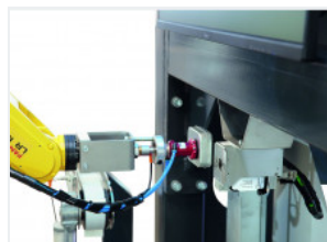
Der Roboter-Arm führt die Box Pixel für Pixel am Druckkopf entlang – und das mit einer CNC-ähnlichen Präzision von 50 µm oder 0,05 mm. (Bild: INperfection/SEW)
