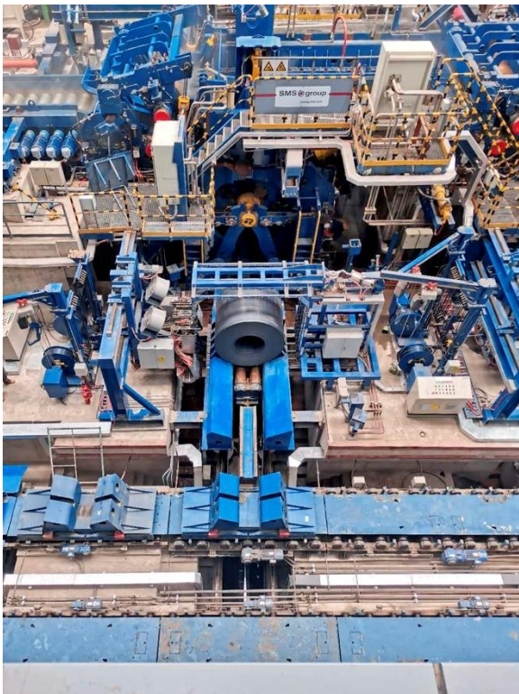
Einer von insgesamt drei Warmbandhaspeln der neuen Hochleistungs-Warmbandstraße von HBIS Laoting.
