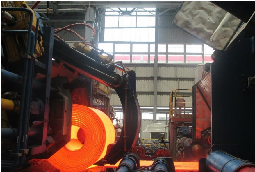
Die dornlose Coilbox reduziert die Temperaturverluste des Vorbandes und speziell die der inneren Windungen.
