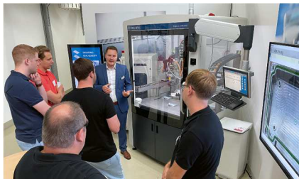
Konturqualität sichern: Dynamic contour dispensing mit Echtzeit-Qualitätsprüfung mit Vision-System
